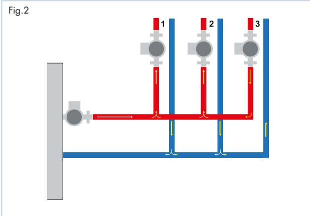
Con il Separatore idraulico si può avere un circuito di produzione primaria a portata costante ed un circuito di distribuzione secondario a portata variabile gestito dalle pompe dell'utenza. In fig. 1 è rappresentato il flusso in condizioni di equilibrio tra richiesta del secondario e la risposta del primario. In fig. 2 è rappresentato il flusso in condizioni di circuito primario con portata maggiore della richiesta del secondari. Il fluido in eccesso ritornerà al generatore di calore.
