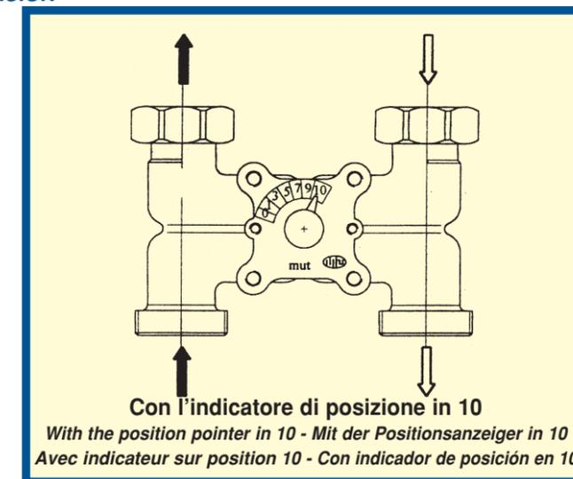
La valvola deve essere installata nel circuito idraulico rispettando il senso del flusso specificato sull'esempio di applicazione. La necessità di avere l'inversione di flusso in una via, comporta l'inversione in tutte le altre vie.
