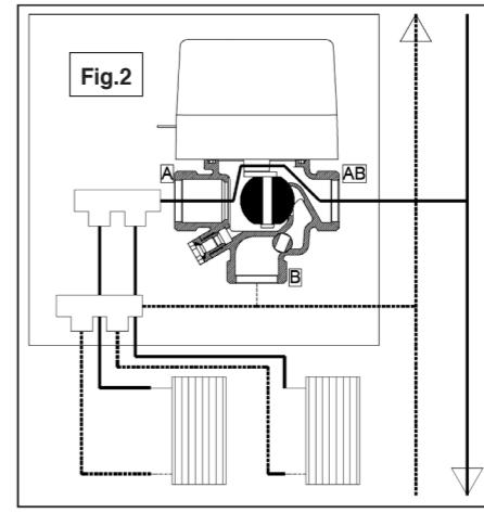
CON alimentazione elettrica - WITH electricity - MIT elektrischer Speisung - AVEC alimentation électrique - CON alimentación eléctrica
