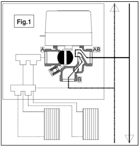
SENZA alimentazione elettrica - WITHOUT electricity - OHNE elektrische Speisung - SANS alimentation électrique - SIN alimentación eléctrica
